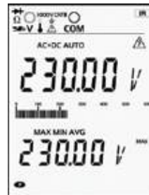
MAX/MIN AVG Muestra los valores máximo, mínimo y medio
