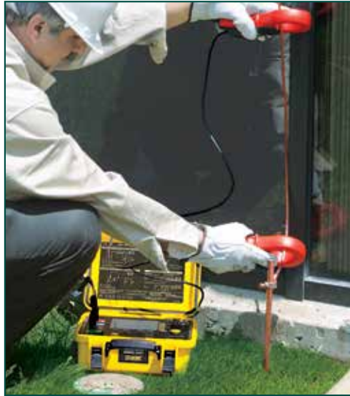
El modelo 6471 mide rápida y fácilmente el valor de la tierra usando el método de doble pinza (no se requieren picas auxiliares).
