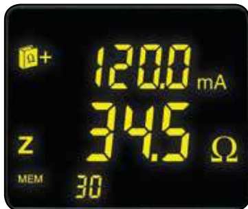
Muestra la corriente de fuga y la impedancia del bucle en la frecuencia de prueba
