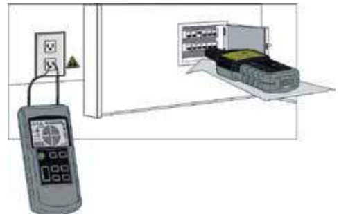
Identificación de interruptores de circuitos Conecte el transmisor a una toma de CA para identificar fácilmente el interruptor correspondiente
