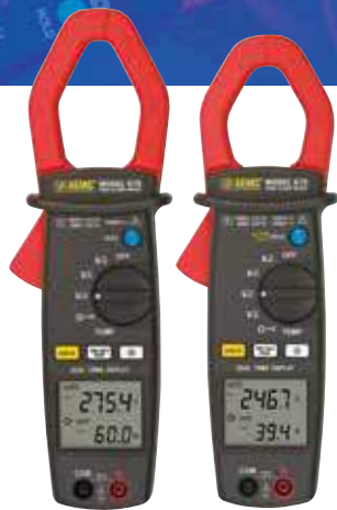
Modelo 670 Abertura de la pinza: 42 mm (1,65 pulg.) Tamaño del conductor: un cable de 750 kcmil o dos cables de 350 kcmil
