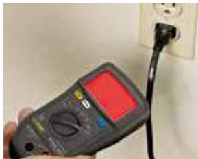
Detección de tensión de red sin contacto (función NCV, sólo para CA)
